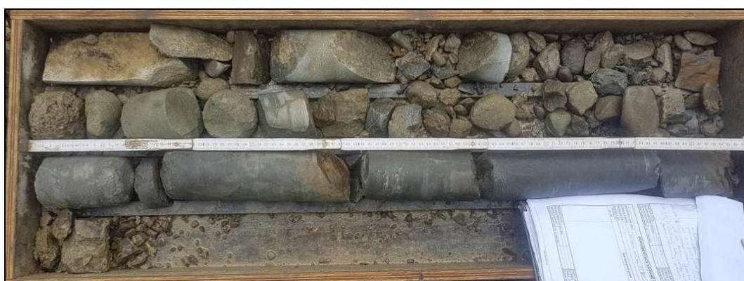
Obr. č. 4 - diagnostický vrt do konstrukce Š2/37,120
