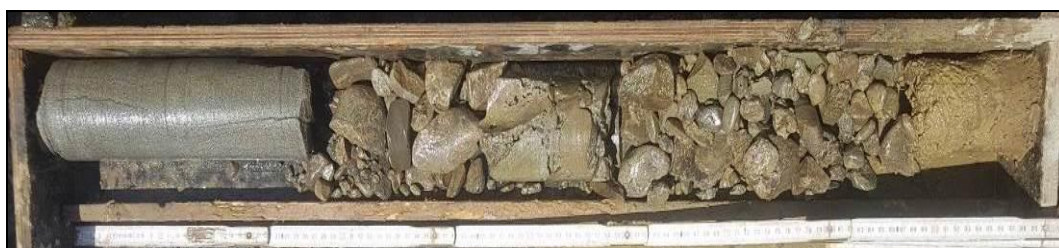
Obr. č. 3 - diagnostický vrt do konstrukce V2/37,120
