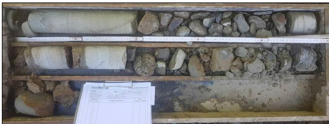
Obr. č. 2 - diagnostický vrt do konstrukce Š1/37,210
